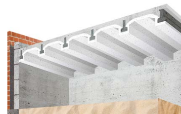
PS-insulatievloer zonder Easy Inserts Bouwjaar van 1983 tot 1992. Rc = 1,3 m2K/W
