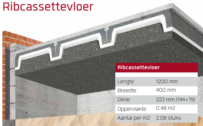
Ribcassettevloer met Easy Inserts Rc-waarde totale vloerconstructie = 4,82 m2K/W
