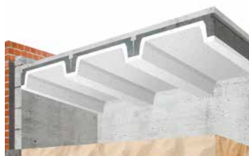
Ribcassettevloer zonder Easy Inserts Bouwjaar van 1983 tot 1992. Rc = 1,3 m2K/W
