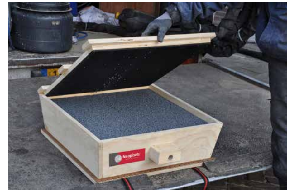
Spouwmuren worden opgevuld met hoogwaardige grafietparels
